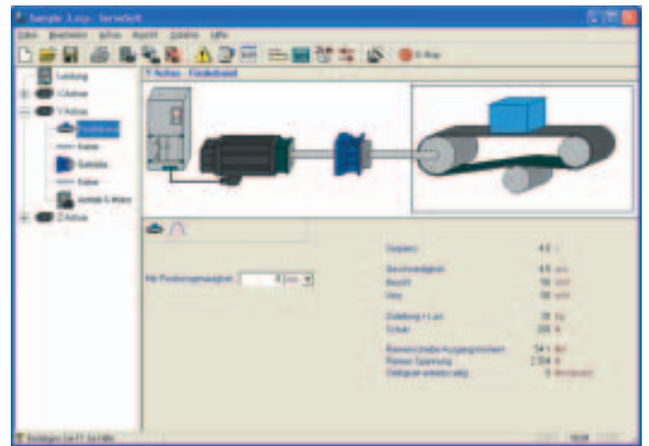
Berechnet werden Kugelumlaufspindel, Riementrieb, Zahnstange, Wickler, Linearmotor – insgesamt 13 unterschiedliche Antriebsmechanismen, die noch laufend erweitert werden. Auch Vorlagen für Querschneider, Fliegende Schere und Ablängsysteme sind verfügbar.
