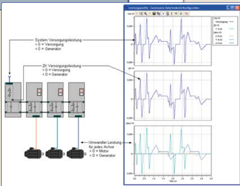
CAE-Tool zur Berechnung des gesamten elektrischen und mechanischen Antriebssystems. Im Bild eine hochdynamische Multiachs-Anwendung.
