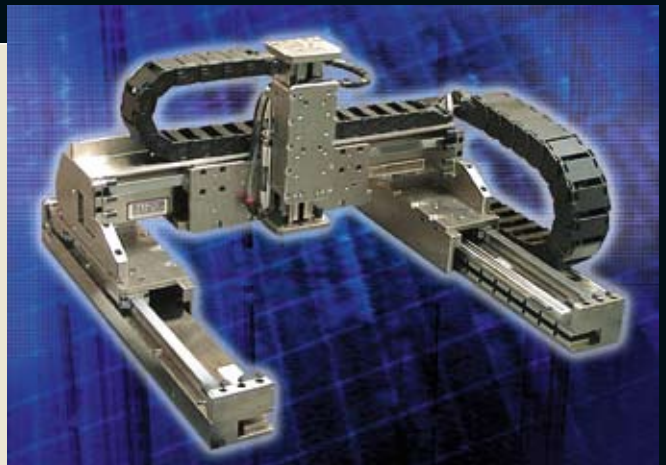
Bis zu 20 Achsen lassen sich dimensionieren. Hier ein mit ServoSoft berechnetes XYZ-Linearsystem von Baldor.
